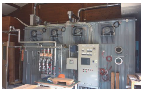
図 2.3. 人工乾燥の例(蒸気式)
